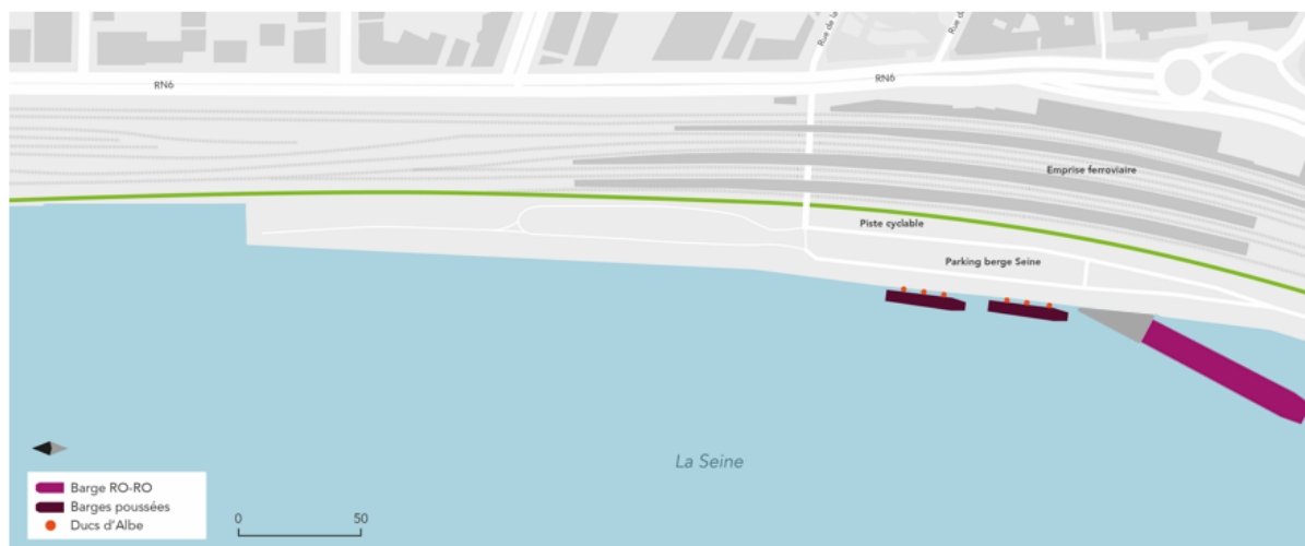
Figure 6: Schéma de la configuration d'amarrage – scénario 2 pour la barge de 79m et 2 barges de 38m
