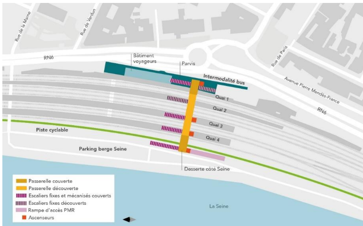
Figure 1 : Les aménagements prévus pour la passerelle piétonne.
