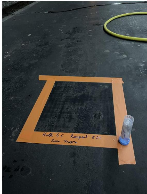
**ANALYSE ICP CONCENTRATION SURFACIQUE DE POUSSIERES DE PLOMB
